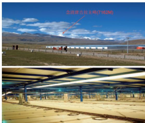
图6 万平米ARGO实验厅(上)和厅内的RPC“地毯”(下)
