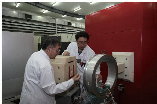
图5 四圆衍射谱仪实物图
