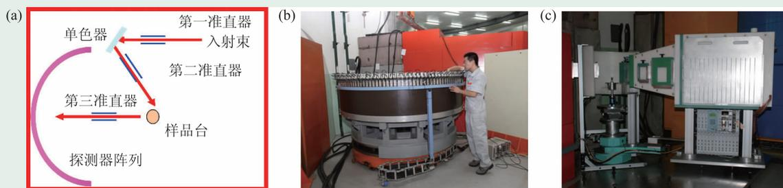
图2 (a)粉末衍射谱仪工作原理示意图；(b)高分辨粉末谱仪实物图；(c)高强度粉末谱仪实物图
