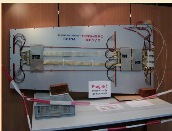
图6 2002年,北大组制作的第一个FW-RPC全尺寸样品经过测试完全达到要求,在CMS大厅作为成果展示了两个月
