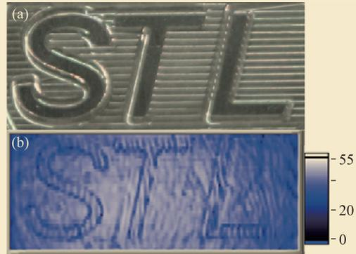
图7 (a) 刻有“STL”字样的铝板照片; (b) 将该铝板置于 FedEx 信封中, 采用逆合成孔径雷达成像, 分辨率为  $0.4 \times 0.6 \text{ mm}^{[20]}$
