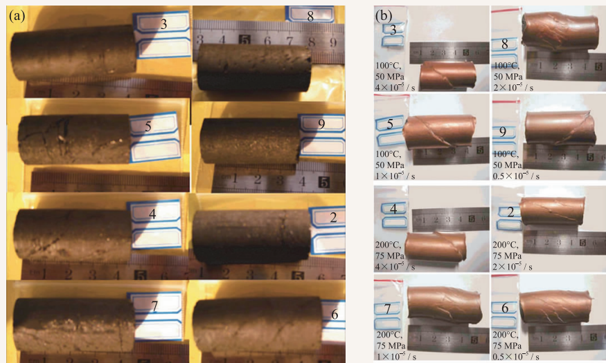
图2 煤岩变形实验前后特征对比 (a)变形前样品;(b)变形后样品 [12]
