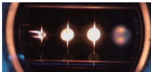
图6 日本宇宙航空研究开发机构(JAXA)在国际空间站上开展的多液滴燃烧实验
