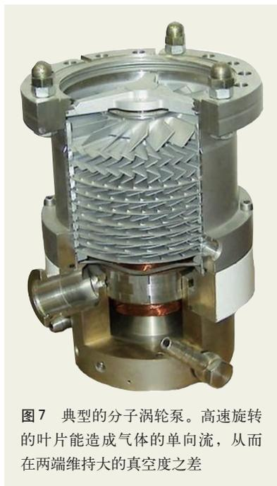
图 7 典型的分子涡轮泵。高速旋转的叶片能造成气体的单向流, 从而在两端维持大的真空度之差
