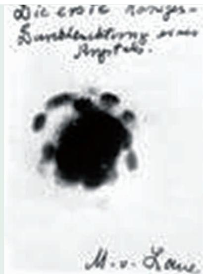
图4 第一张硫酸铜晶体X射线衍射斑点图
