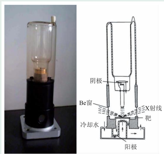
图9 密封式X射线管
