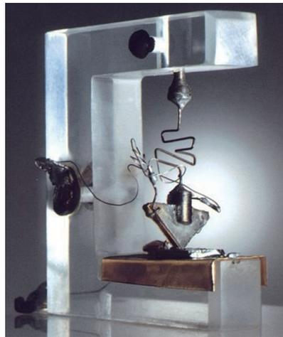
图1 贝尔实验室保留的锗三极管原型器件
