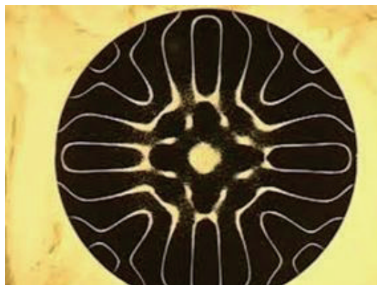
图3 圆盘上振动的沙子所显示出来的 cymatic 图像
