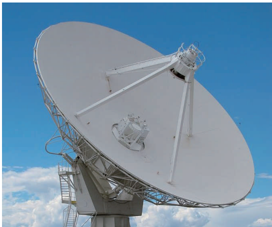
图3 抛物面型大锅。取决于其表面反射的波谱，它既可以用来烧水也可用来测量宇宙的背景辐射
