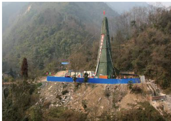
图3 2008年5月12日汶川8.0级大地震后，科学家在地震断层带上实施科学钻探，通过在断层带上采集岩心和随钻进行的各项物理测量，理解地震发生时在断层上究竟发生了什么。如图是在龙门山断裂带中北段实施的汶川科钻三号孔的现场作业情况
