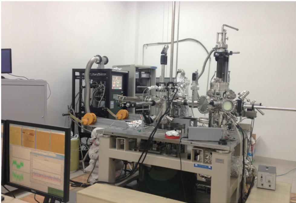
图2 极低温强磁场扫描隧道显微镜(STM)和分子束外延(MBE)联合系统
