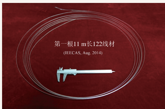
图7 世界第一根10 m量级高性能铁基超导长线 [32]
