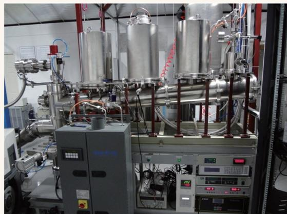
图3 PandaX的制冷和气体循环系统示意图。倾斜的管道是制冷总线，上面的不锈钢罐体里是不同的功能模块
