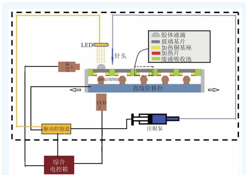
图1 胶体材料箱实验工作原理示意图
