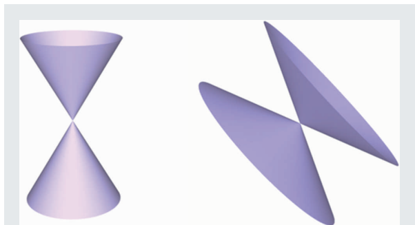
图1 两种类型的外尔点周围能带:直立锥体(第一类外尔点),倾斜锥体(第二类外尔点)
