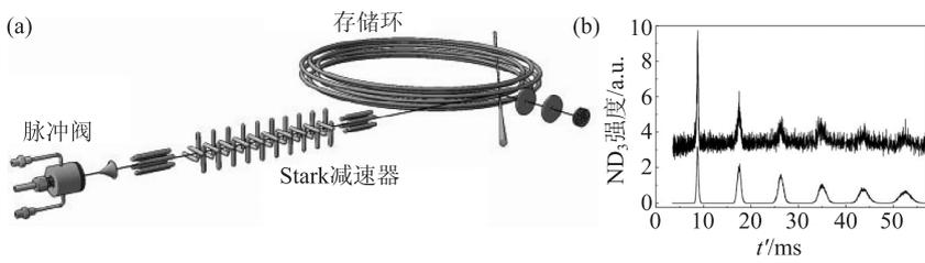
图12 ND<sub>3</sub>分子静电存储环的(a)实验装置与(b)结果
