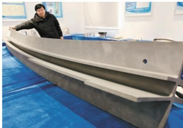
图3 3D打印的C919中央翼缘条<sup>[48]</sup>
