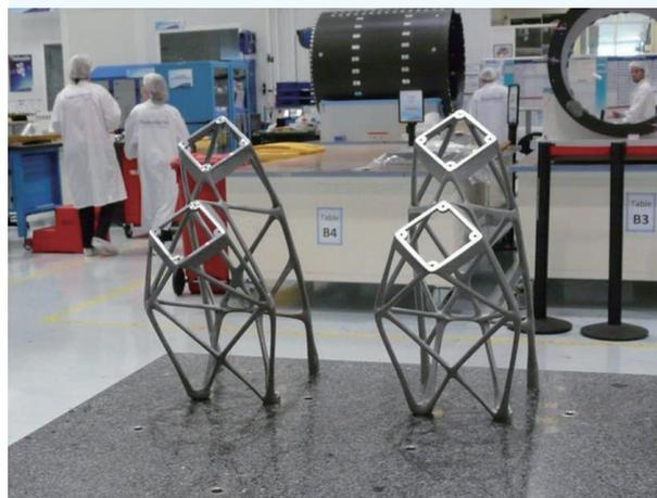
图4 通讯卫星上使用的3D打印轻量化构件<sup>[51]</sup>
