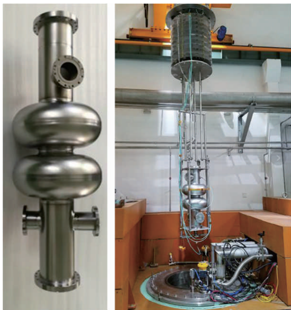
图9 CEPC主环上的、650 MHz超导高频腔样机及其垂直测试 [12]
