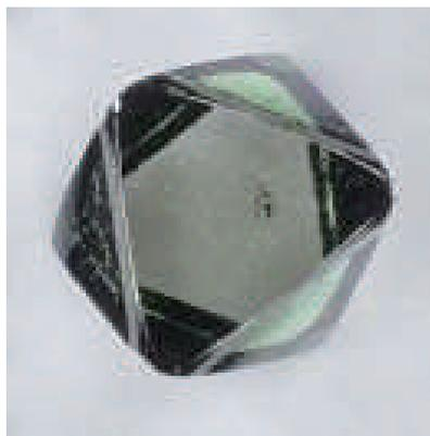
图1 长成凸多面体的金刚石颗粒
