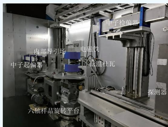
图7 CSNS为磁性薄膜研究量身定做的多功能反射谱仪
