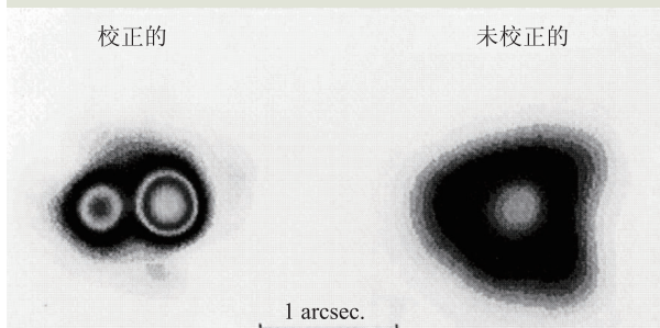
图5 COME-ON系统对Andromeda γ2双星的自适应校正成像
