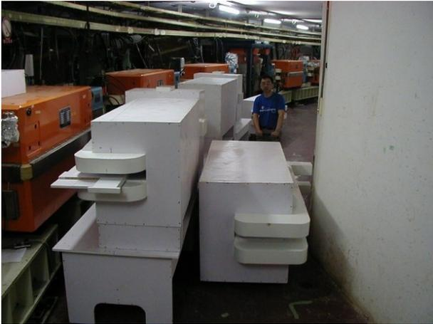
图3 BEPC隧道里为平行放置两个储存环而进行的木模实验
