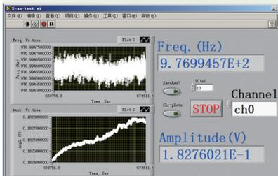
图13 新型锁相频率计对一个977 Hz实际信号的测量结果(监控持续约80分钟)
