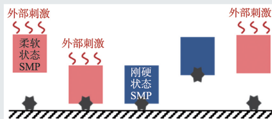
图1 形状记忆聚合物万能抓手抓取和释放物体的示意图
