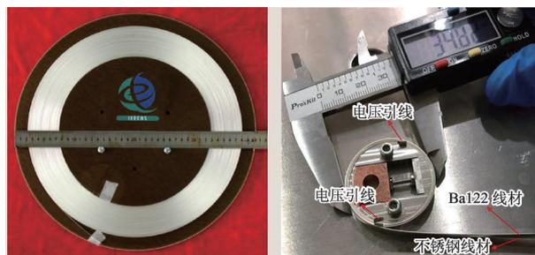
图4 世界首根百米量级铁基超导长线<sup>[83]</sup>
