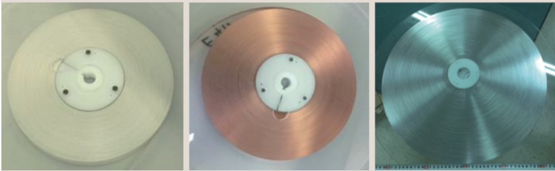
图6 MOD法制备的500 m级RE123带材的不同保护封装后的外形: 镀银保护、镀铜及封装产品的外形
