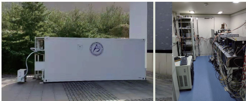
图3 可搬运钙离子光钟。左图：车厢外观；右图：车厢内部
