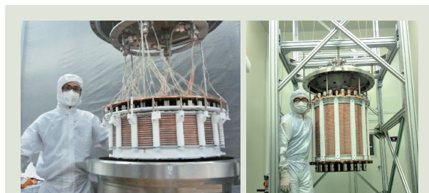
图5 左侧为PandaX-I, 120 kg液氙探测器(2009—2014), 高约15 cm, 直径60 cm; 右侧为PandaX-II, 580 kg液氙探测器(2014—2019), 高约60 cm, 直径约65 cm [23]
