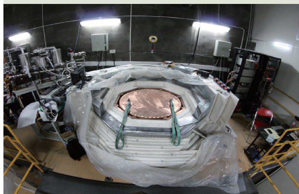
图 4 PandaX-II 实验探测器。从外到内依次为铅、塑料材料的聚乙烯和高纯铜。高纯铜内部不锈钢容器中盛放的是用于探测暗物质的氙 [23]
