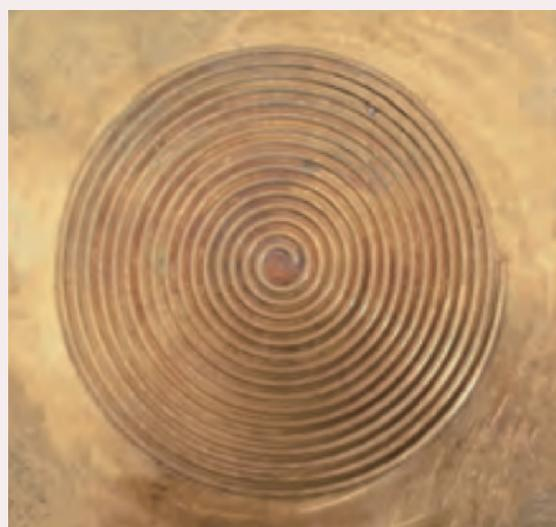
图9 在铜板上刻蚀的阿基米德螺旋线，用其实现了声涡旋<sup>[71]</sup>
