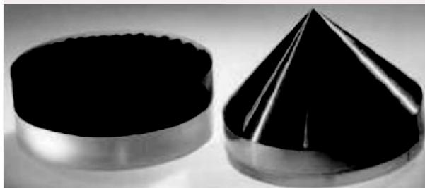
图15 全吸收靶(左)和全反射靶(右)的实物照片<sup>[82]</sup>
