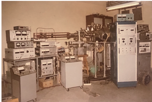
图3 我国研制的第一台分子束外延设备
