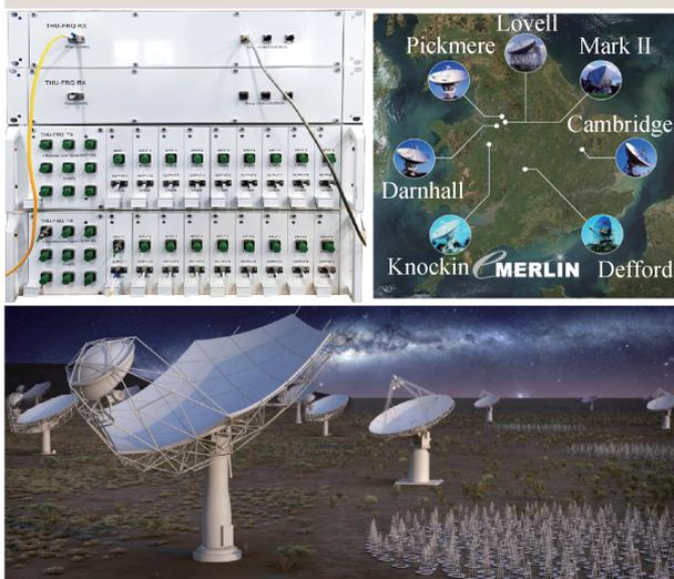
图5 清华大学课题组研发的SKA 光纤频率同步设备(左上图),应用于平方公里阵列射电望远镜(下图)<sup>[42]</sup>和英国e-MERLIN 望远镜阵列(右上图)<sup>[43]</sup>。其中,右上图中的英文是e-MERLIN 望远镜阵列各望远镜所在的地名或望远镜名称
