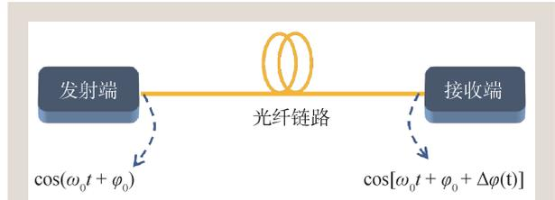
图2 光纤频率传输示意图
