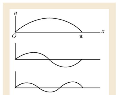
图4 一根弦的振动模态, 从上到下依次为基频、二次谐波(八度)和三次谐波(纯五度)<sup>[9]</sup>
