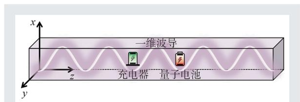
图1 量子电池方案示意图：在矩形中空金属波导管中放置两个无直接耦合的二能级系统，分别作为充电器和量子电池
