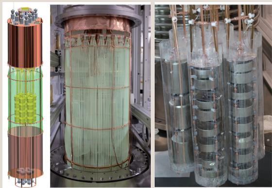
图6 GERDA 实验装置中的液氩反符合探测器结构示意图(左), 探测器周围的光纤(中)以及探测器阵列实物图(右)<sup>[29]</sup>
