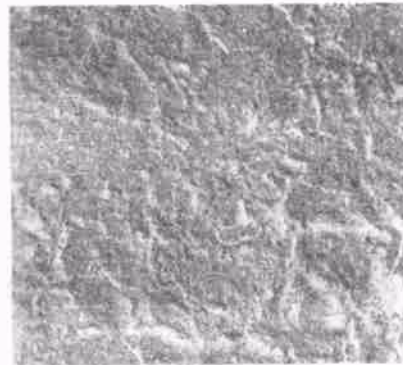
图15 爆炸烧结大颗粒金刚石聚晶的岩相观察,电子显微镜照片( \times 2000 )
