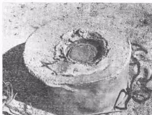
图 12 爆炸法烧結大颗粒金刚石, 爆炸后, 容器完整密封并陷于铅锭坑内
