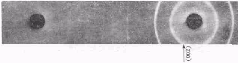
图 16 爆炸烧结大颗粒金刚石聚晶的 x 射线衍射照片,由于压装密度不合适,发生“石墨化”现象,照片中出现石墨最强的(002)线。
