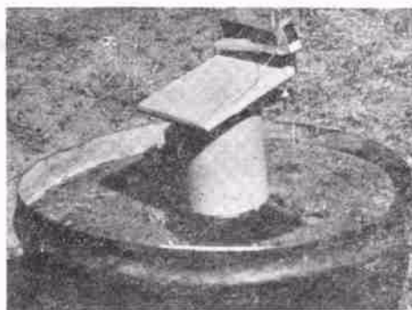
图 7 铅锭收集法装置
