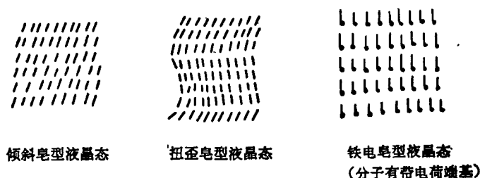
图 5 皂型液晶态中变形态示意 (磁场, 机械力, 声波等外界刺激时构型变化)
