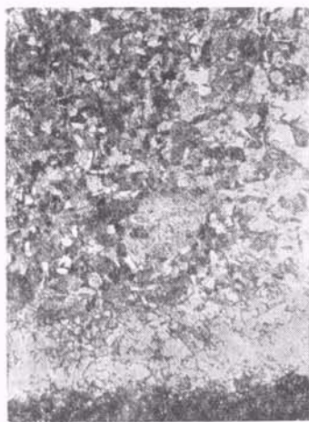
图2 Ni-MnB合金开始熔融时与石墨的相互渗透 180×
