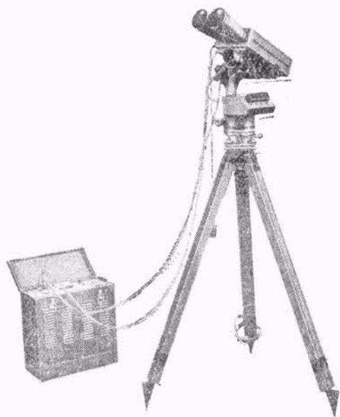
图1 中近程激光测距仪外形图
