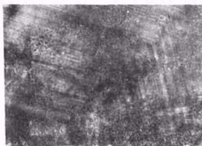
图 15 生长过程中温度波动的周期短且波动次数多的情况下所得晶体的生长层
