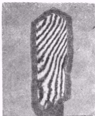
图 16 c 切 ZnO 晶片的干涉图
