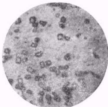
图2 未经磁化处理的结晶体
