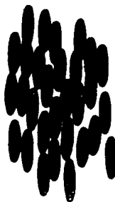
图 5 向列型液晶分子的排列结构
