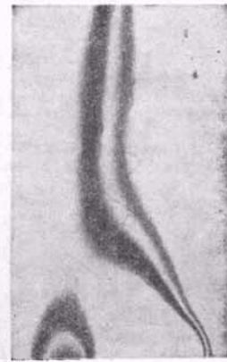
图 6 不均匀弯曲合成云母晶片透射形貌图
