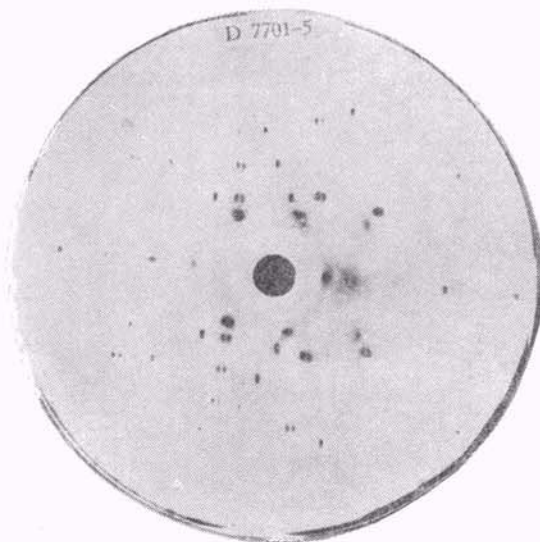
图6 由图5G区拍摄的劳厄衍射斑点 ● 基体晶粒衍射斑点; ■ 孪生晶粒衍射斑点
