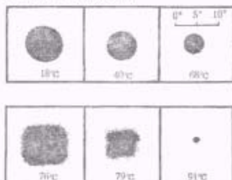
图 12 PPTA 液晶升温时 H_V 散射的变化
