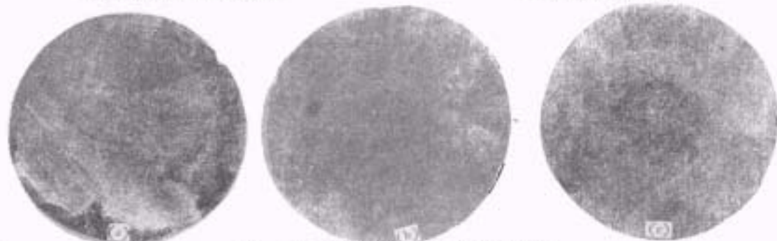
图 5 [115] 生长的硅单晶横断面微缺陷腐蚀图案 (a) 云雾状图样；(b) 均匀分布的图样；(c) 均匀分布的环形图样
