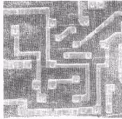
图 4 集成电路 Al 引线的离子刻蚀照片
