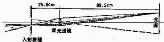
图3 聚光系统光路示意图
