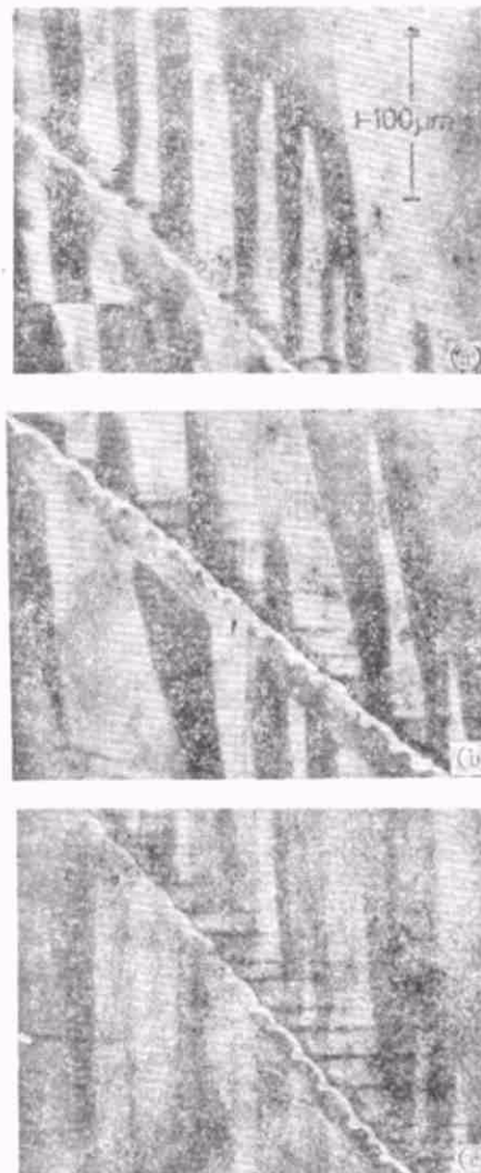
图4 磁衬度随加速电压 E_0 的变化(Mn-Zn铁磁体, 束流~10nA, 试样倾角45°)
